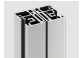
zipSCREEN.2 Freistehende Führungsschiene 68 x 53 mm. Empfohlen als freistehende Führungsschiene, z. B. vor einer Schiebetür, wenn keine Schienenbefestigung Richtung Fenster-Blendrahmen möglich ist
